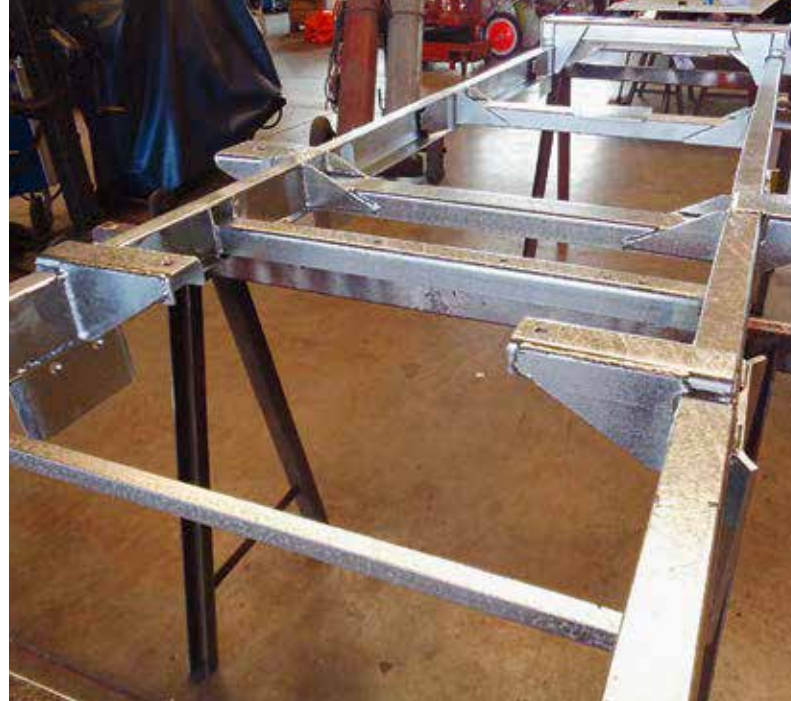
Nachher: ausgebesserter und frisch verzinkter Rahmen
