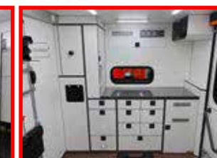
Schrankanordnung: Beladung wird im großen Schrank an der linken Heckseite und im Schrank an der Stirnseite verstaut.
