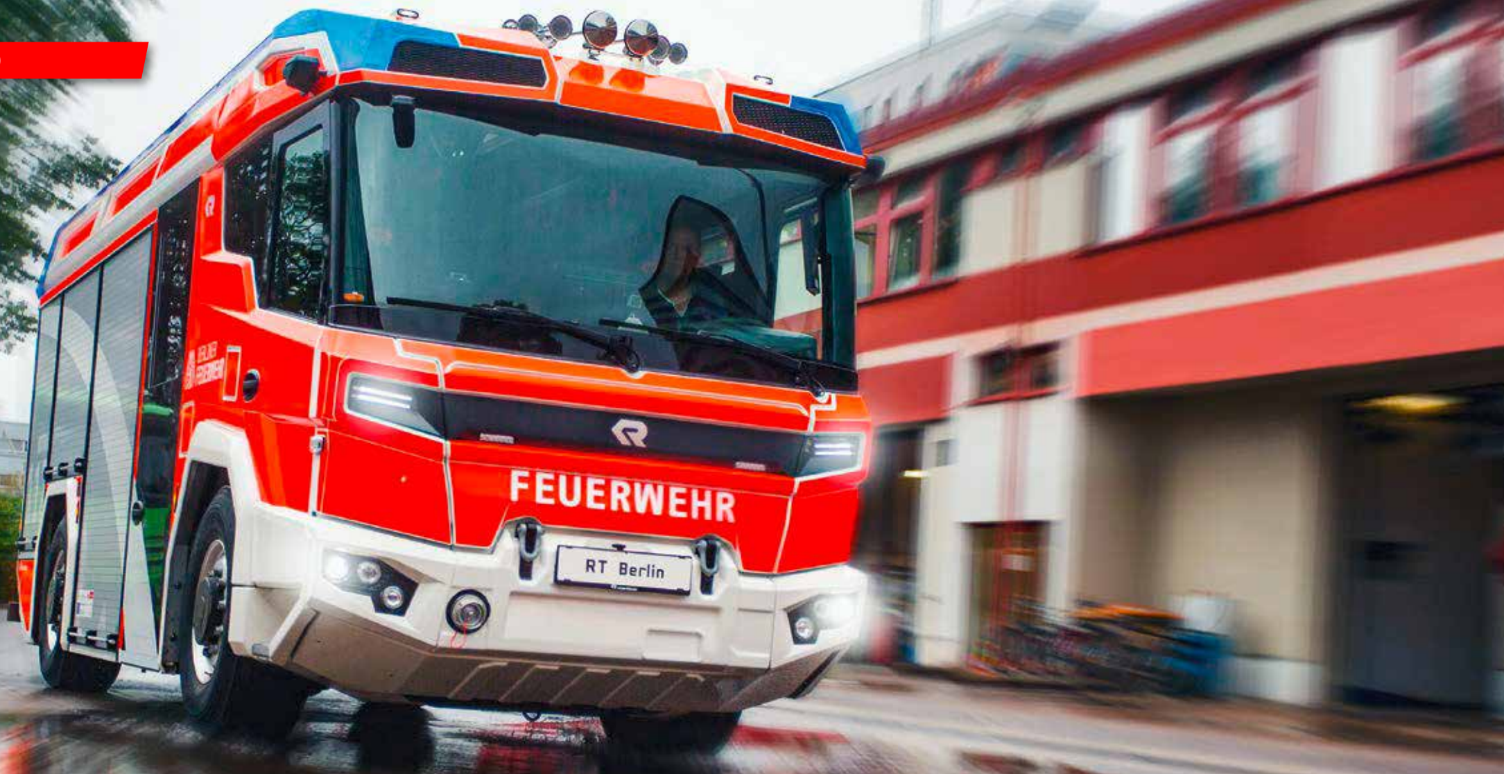
Höchstleistung unter Strom: das neue elektrisch betriebene Löschfahrzeug Bild: Andreas Friedrichs
