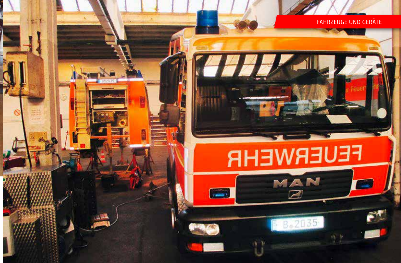
Die Fahrzeuge fachgerecht zerlegt: hinten der demontierte Aufbau, vorne der Antrieb und das Fahrgestell
