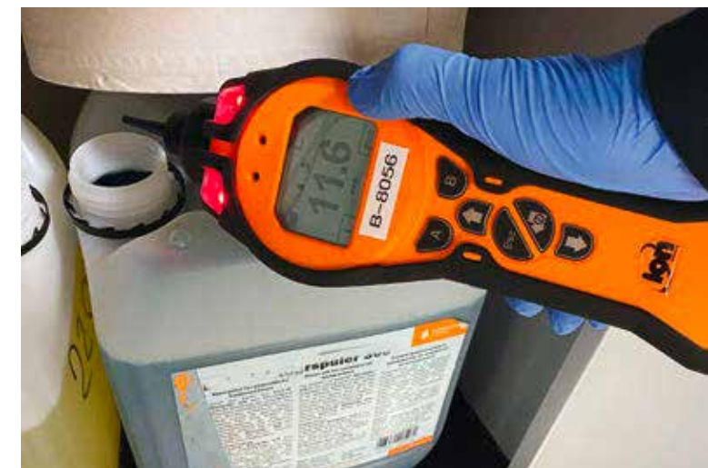
Der Photoionisationsdetektor (PID) misst Konzentration und Ausbreitung.
