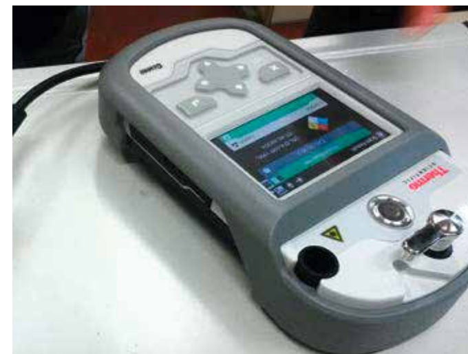
Das Infrarotspektrometer Gemini analysiert Stoffe. Bilder: Berliner Feuerwehr
